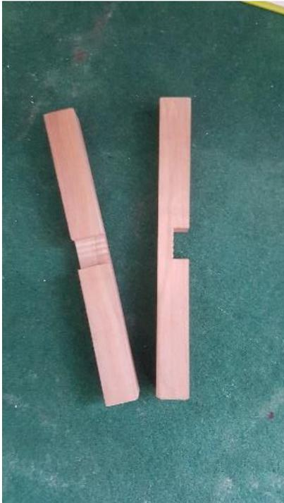
Ein Vierkantholz, etwa 10 Zentimeter lang, in der Mitte eine Kerbe eine Schwachstelle. Es hält einiges aus, aber wenn es zu stark belastet wird, wird es genau an dieser Stelle brechen.
